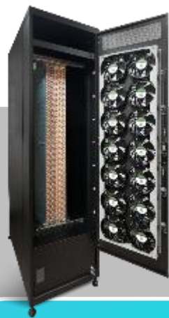
液冷機櫃 CDU / 風扇牆
