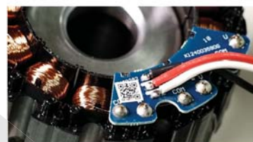
每一個生產部件透過 QR Code 數據管理，確保產品品質同時也落實產品溯源管理。
